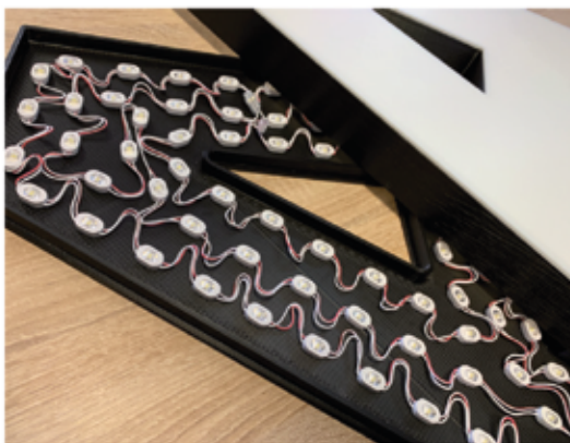
Die gedruckten Buchstaben bestehen aus dem Boden, der die LED-Module aufnimmt, dem Korpus und meist auch einem aufgedruckten Spiegel.
